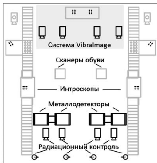
Рис. 2. Типовой сектор контроля досмотрового павильона
